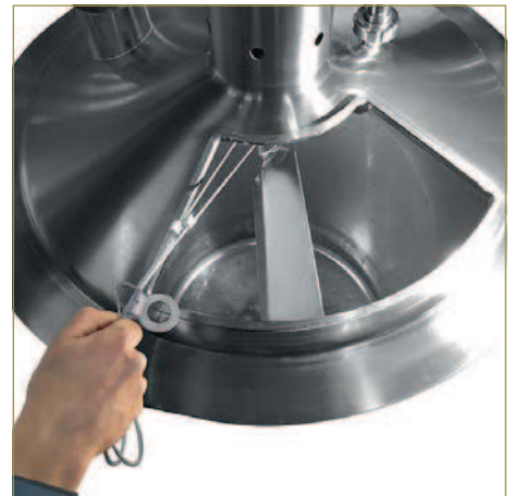
DISPOSITIVO SOLLEVAMENTO PALE AGITATORE PER WHIRLPOOL. AGITATOR-BLADE LIFTING DEVICE FOR WHIRLPOOL.
